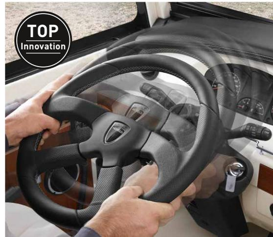
□ **Lederlenkrad abnehmbar** zum bequemen Drehen des Fahrersitzes und komfortabler Neigung der Rückenlehne bei Einbeziehung in die Sitzgruppe – mit Schnellverschluss.
