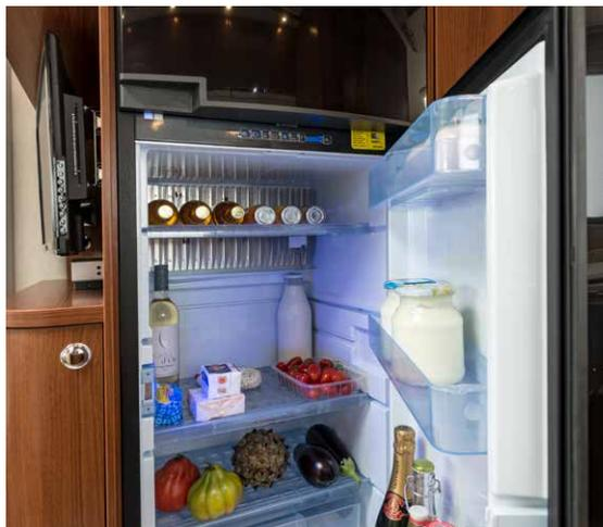
□ **Dometic 190 Liter AES-Kühlschrank mit separatem Gefrierfach** und Gemüsefach. Verstärkte Kühlleistung durch Rundum-Isolation und Abluftführung über das Dach. Für Gas-, 12 V- und 230 V-Betrieb.
