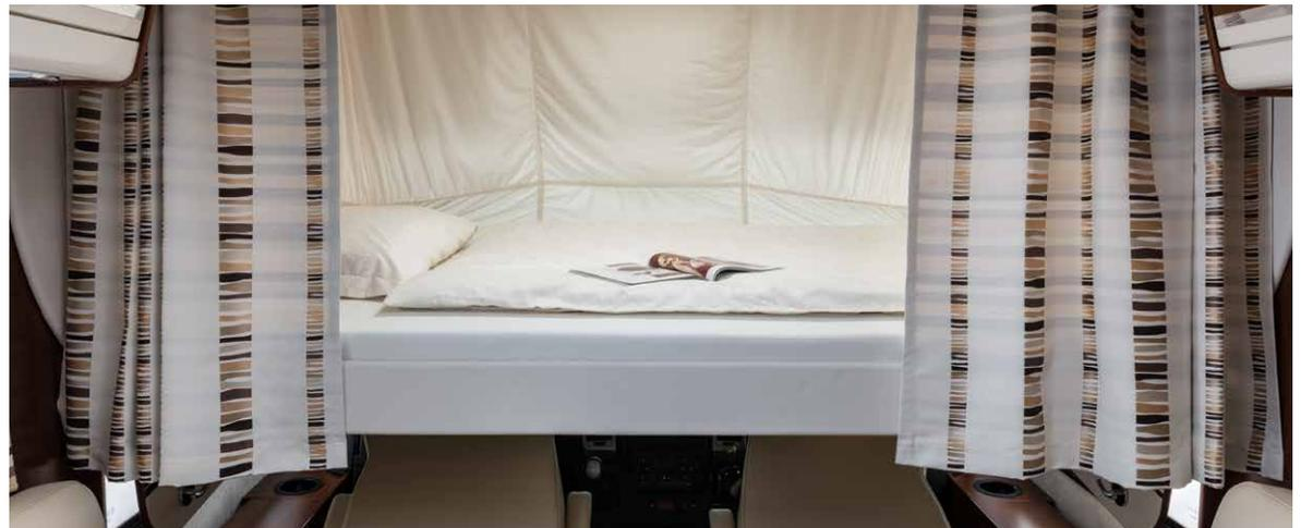
□ **Hubbett mit elektrischer Betätigung** im vorderen Innenraum. Mit dem Hubbett kann der vorhandene Schlafplatz im HOME variabel erweitert werden. Das Bett verfügt über ein punktelastisches Federsystem, Mini-Heki-Dachluke und Leseleuchte.
