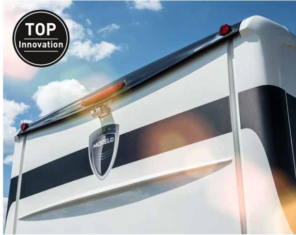
■ **Heckspoiler** reduziert als Luftabrisskante die Verschmutzung der Rückwand. Das Dachprofil leitet Wasser zum Heck und Bug und verhindert so eine Verschmutzung der Seitenwände.
