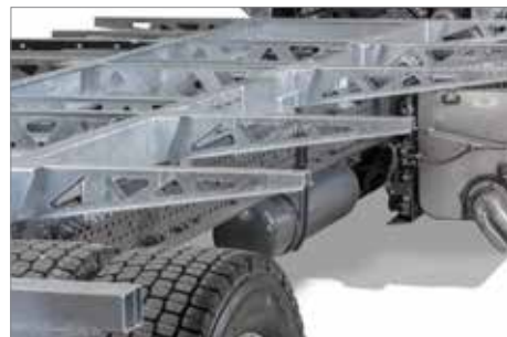
HILFSRAHMEN Die „Grundmauer“ der Wohnkabine
