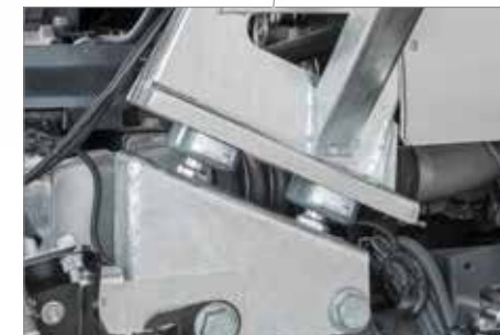
SILENT-BLÖCKE Entkoppeln das Fahrerhauspodest und bringen es zum „schweben“
